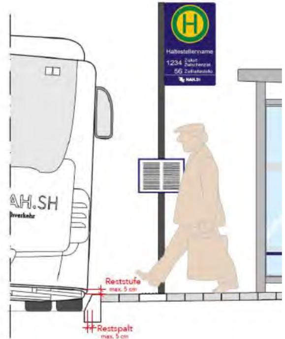
Abbildung 10: Darstellung von Reststufe und Restspalt
