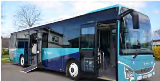
Bus mit Außenschwenktüren und Klapprampe
